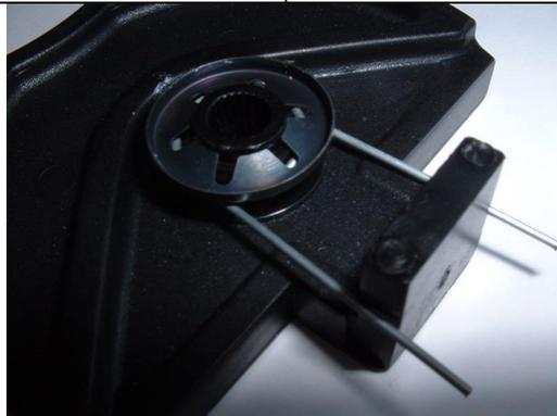
Detailaufnahme Rückstellfeder mit Sicherungsscheibe
