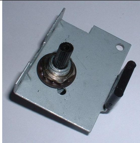
Montage des Potentiometers mit Scheibe und Mutter an dem Montagewinkel
